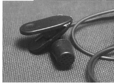
Fig.3 (左) 微小径コンタクトマイクロホン(不採用)
