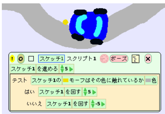
Fig.6 自動で道に沿って走る車 (センサー1つ)
