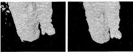
図 16: 復元結果のポリゴンによる表示 (腕周辺の拡大) - 左: d = 1\text{cm} で通常のサンプリングをした形状、右: d = 2\text{cm} で本論文で述べたサンプリングをし、補間をした形状
