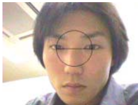
図 2 視点検出において輝度を採取する部位
