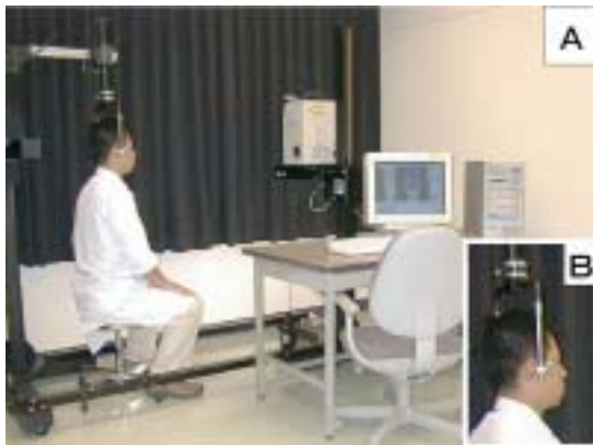
図6 顔面計測用3次元非接触型表面形状計測装置 A：装置の全体像、B：頭部固定装置
