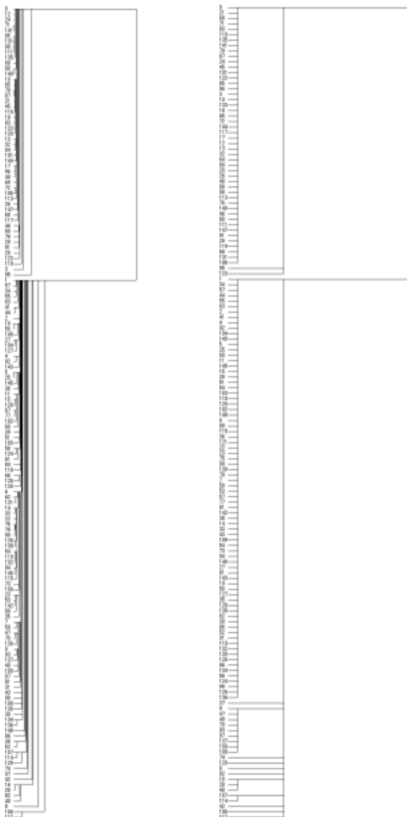
図2 Iris の解析結果から作成した樹形図 左:Single Link 右:提案手法 樹形図の高さは結合したクラスタ間の距離
