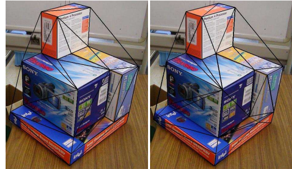
図 10: 図 4 の三角網の最適化の結果。(a) 提案手法 (100%, 2 ラウンド, 8.21 秒)。(b) ランダムフリップ (91.5%, 270 回, 9.05 秒)。
