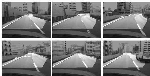
図 16: シーン 2 の画像列 (左上から右へ, 左下から右へ続く 70 フレームごとの連続画像)。ただし, 画像中の色の明るくなっている領域は平面抽出結果を示している。
