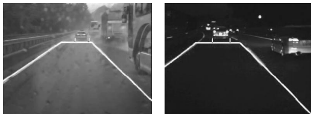
図 9: 悪条件下での先行車両検出例 (雨天, 夜間)
