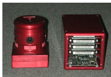
図 1: Ladybug のカメラヘッド (左) と蓄積ユニット (右)
