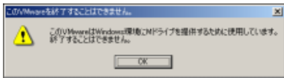
Fig 4: 利用者がVMwareを停止しないように警告をする、VMwrapperが出すメッセージ
