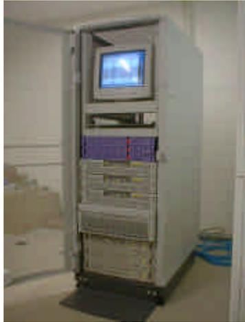
図5 アーカイブサーバと ATM-IP 変換機
