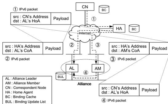
図 6 トラフィック分配機構を HA に設置した場合の Mobile IPv6 SHAKE の通信 (下り)
