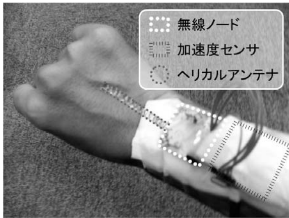
図3 センサノードをテープで装着した状態
