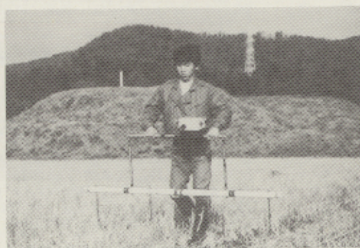
図-15 50 cm 電極間隔のウェンナー法による電気探査風景
