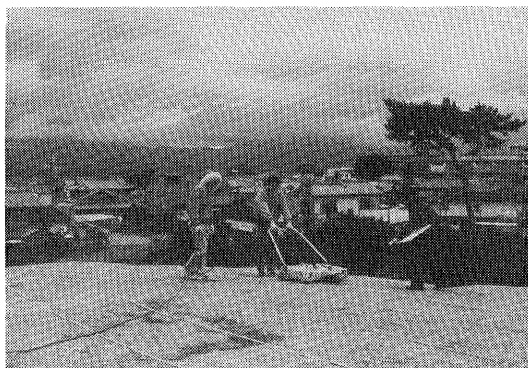
図-3 岸和田市貝吹山古墳の地中レーダ探査風景
