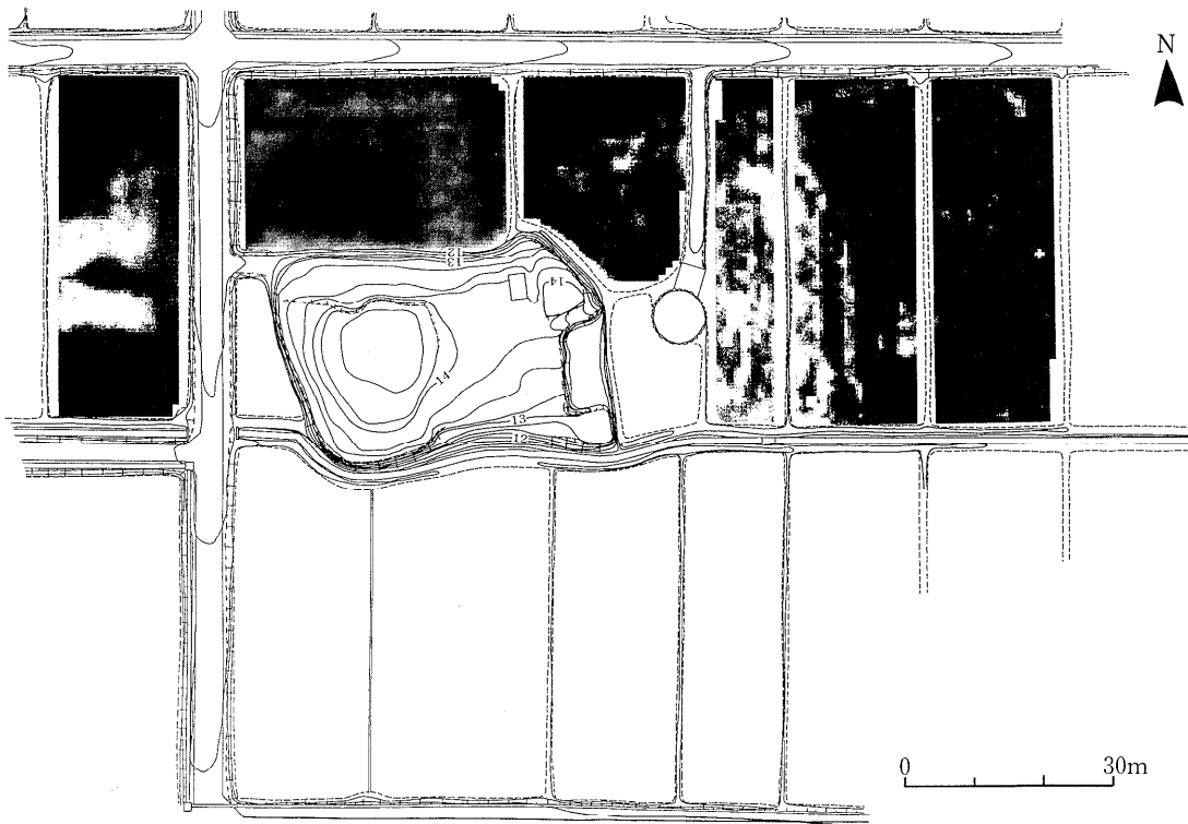
図-16 大垣市長塚古墳水平電気探査結果 (抵抗率 55 \Omega\text{m} \sim 10 \Omega\text{m} )
