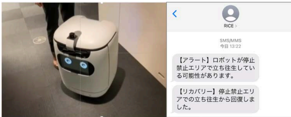
図11 防火扉前で停止した際のエラーメッセージ
