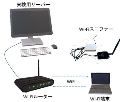
図 5. 実験ネットワーク構成
