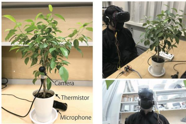
図2 受動的な生起方法のため植物に設置するセンサー類(左図)、受動的な生起方法による植物の疑似体験(上段:体験者の様子, 下段:HMDから視認できる映像)
