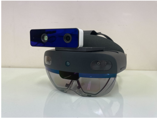
図 5 使用したデバイス。RGB-D カメラを HMD 上部に固定している。
