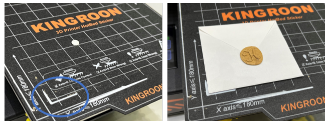
図4 プラットフォームに目印を出力。封筒を正確な位置に配置できる。
