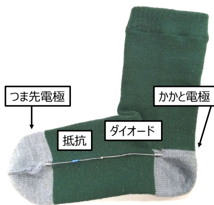
図 6 実装した靴下 (つま先およびかかるとが導電繊維が編み込まれた電極になっている。各電極間にダイオードおよび抵抗を導電糸で縫い付けている)
