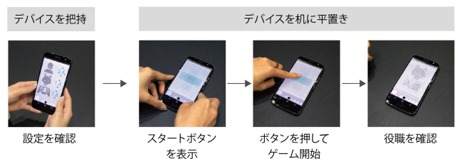
図 9 加速度センサによる画面の切替え。加速度センサを用いて端末の状態 (把持/平置き) を検出している Fig. 9 Example of interaction using accelerometer.
