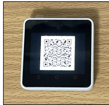
図 2 M5Stack による QR コード表示
