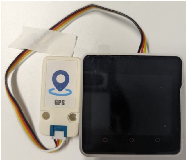
図 4 子機デバイス (M5Core2 と GPS モジュールを装着したもの)
