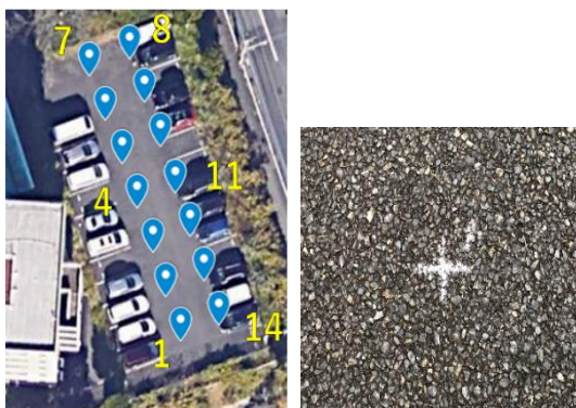
図 12 基準点の配置 (左), 設置した基準点 (右) (地図画像 ©2022 CNES / Airbus, Digital Earth Technology, Maxar Technologies)
