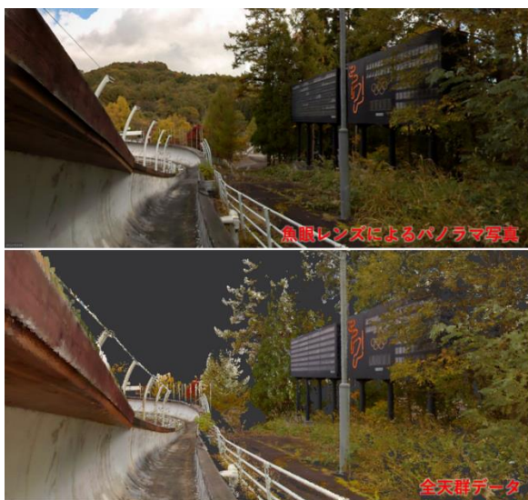
図5 パノラマ写真(上)と生成した点群(下)
