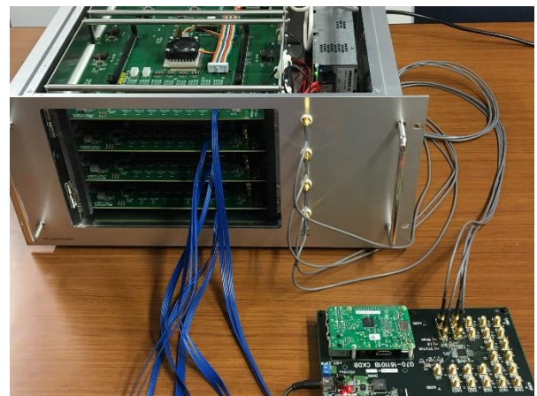
図 2. Fic ボードを接続した FPGA クラスタ
