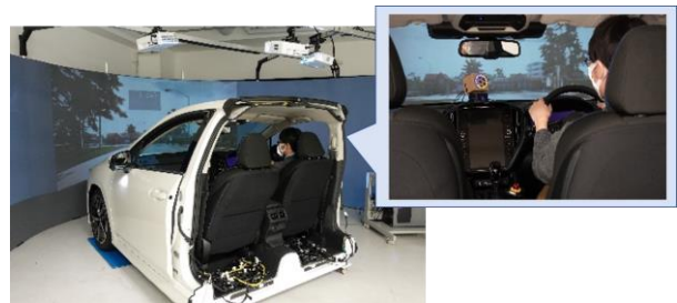
図2 コックピットモック型ドライビングシミュレータを用いた実験の様子
