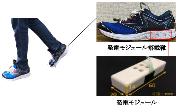
図 2 発電モジュール搭載靴を装着した様子
