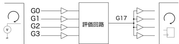
図 5 s27(4 入力 1 出力)の評価モデル
