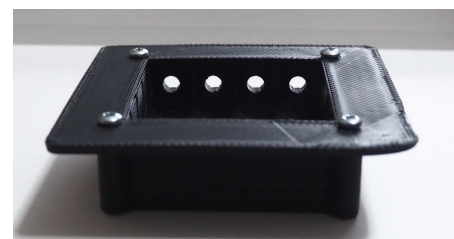
図 9: LED 光源の取り付け部。底面と側面の穴に差し込む。
