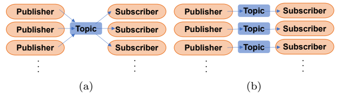
図 2 (a) 同一トピックへ出版購読を行う複数ノード通信モデル (b) 異なるトピックへ出版購読を行う複数ノード通信モデル
