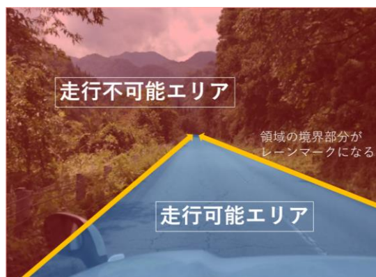
図7 エリア認識に基づくレーンマーク推測図
