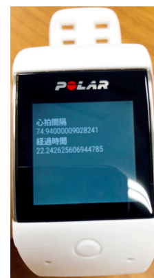
図 2 Wear OS by Google 搭載の Polar M600 を用いた心拍間隔と経過時間取得アプリケーションソフトウェア
