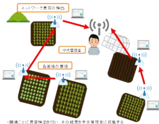
図 1 農業 IoT センサネットワークのシステム構成
