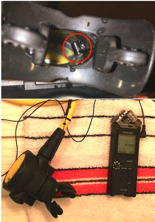
図 1 水中音声記録用デバイス: ダイビング用レギュレータの内部に防水の TS モノラルマイクが固定されている。
