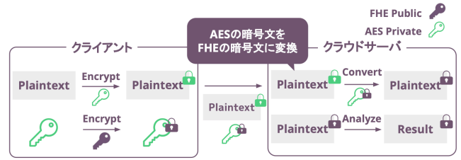
図2: Lauter ら [1] の提案した手法。平文を AES で暗号化し、AES の鍵だけを FHE で暗号化することで暗号化の高速化が可能。FHE で暗号化するデータが最大でも AES の鍵長になる。
