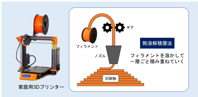
図 1 家庭用 3D プリンターの例 (Prusa i3 MK3S)*1 と熱溶解積層法の概要図
