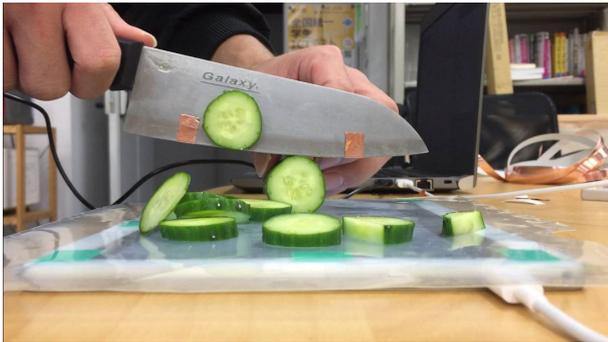
図 4 提案システムを用いてきゅうりの小口切りを計測する様子。
