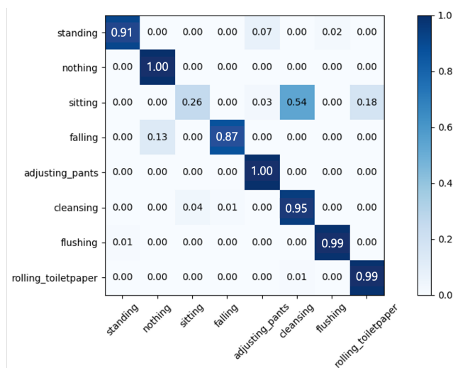
図 10 タグアレイ画像の混同行列 平均精度=90.34%
