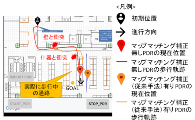
図 11 マップマッチングによる歩行軌跡の補正で一本奥の通路に補正されたケース
