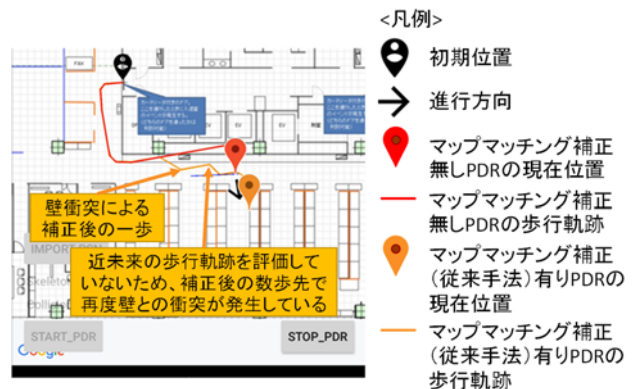
図 10 補正後に数歩歩行した先で再度壁との衝突が発生した時の歩行軌跡
