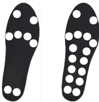
図4 圧力センサの増設(左:改良前, 右:改良後)
