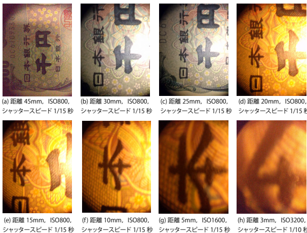
図 2 フラッシュライトを点灯したうえで撮影した。暗くはなるが、ISO とシャッタースピードの調整で修正できる範囲に収まった。かなり近い距離でも精細に見えていることが分かる。
