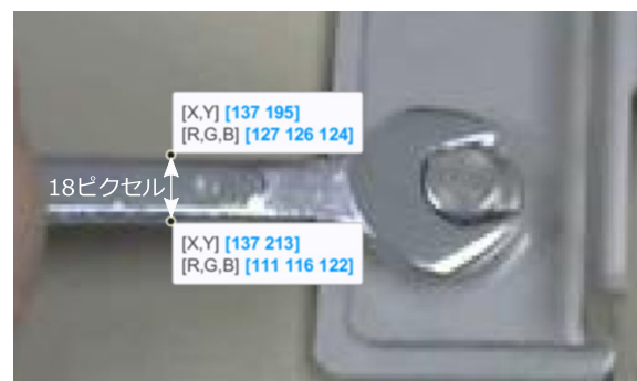
図 12 スパナの検出精度の指標 Fig. 12 Index of prediction accuracy for Spanner.
