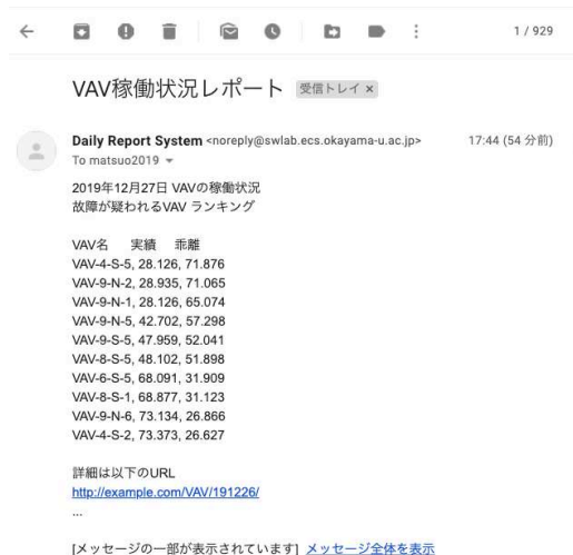
図 9 故障が疑われる VAV のメールによる通知
