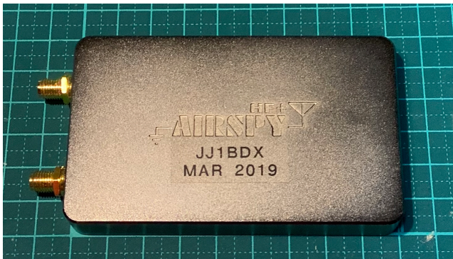
図 2 Airspy HF+ Dual Port の写真 Fig. 2 Photo of Airspy HF+ Dual Port.
