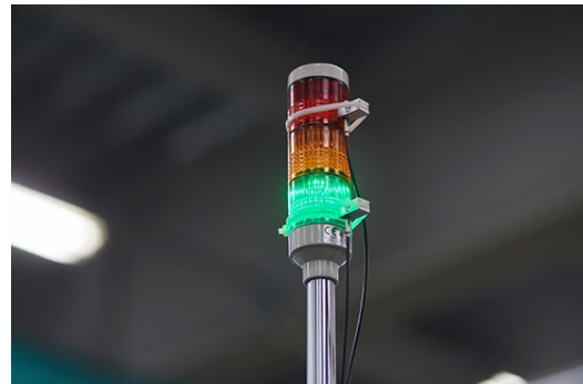
図1 機械に備わっているシグナルタワー Figure 1 The signal tower on the machine
