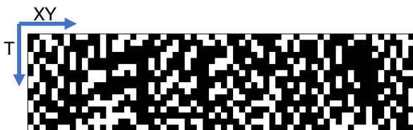
図 7: XY-T 図. ここでは縦軸に時間次元を横軸に空間次元を示す. これは, 短時間露光や長時間露光よりも時空間的にスパースな露光が行動認識により適していることを示している.
