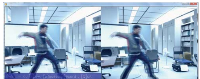
図 5 3D 遅延同期ビデオフィードバックのアウトプット例；左側に左目用映像，右側に右目用映像が提示される．左右両映像ともに，練習者の動作と参照の動作とが重畳されている．
