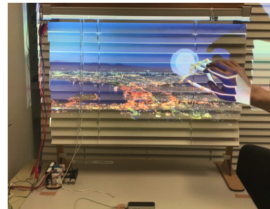
図 17 LeapMotion (正面下部) によって、触れる場所によって投影するコンテンツの切り替えなどを行うことができる。
