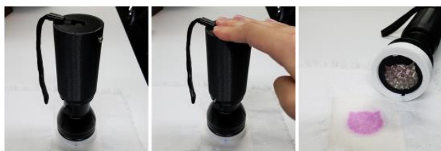
図 14 スタンプ描画の一連の動作。UV スタンプライトをキャンバスに押し付け (図左), 持ち手を押下して最後まで押し込む (図中)。UV ライトを離すと、型の穴の形に発色した絵が残りスタンプ完成 (図右)。
