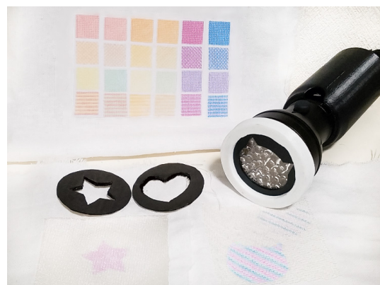
図1 本研究のコンセプト. UV 刺繍糸を用いて幅広い色彩表現が可能なインタラクティブキャンバスを構築し、UV ライト等を組み合わせた柔軟な入力手法を提案する。
