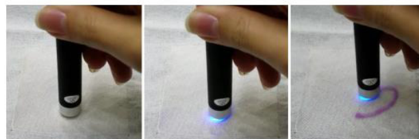
図10 レーザーポインタでキャンバスに描画する一連の動作。描画開始点でレーザー照射を開始し、照射したまま動かすとレーザーの軌跡が発色し、線画となる。
